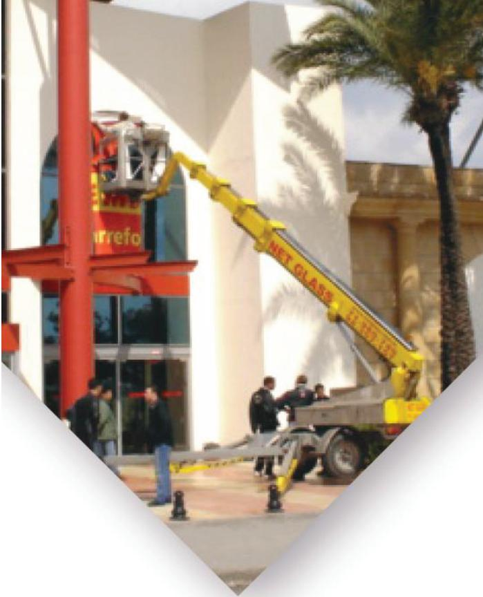
⤴ Nacelle électrique (batterie 24 V) tractable, pour le travail de 2 personnes jusqu'à une hauteur de 21 m. Cette nacelle est très rapidement mise en place. Idéale pour les lieux présentant de fortes contraintes d'accès (encombrement, charge au sol admissible).
